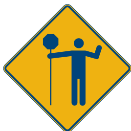
Signal avancé de la présence d'un signaleur
